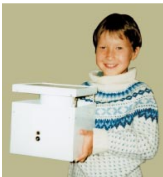
Рис. 1. Макет наноспутника “MUNIN” с пассивной магнитной системой ориентации (без солнечных батарей и штыревой антенны)
