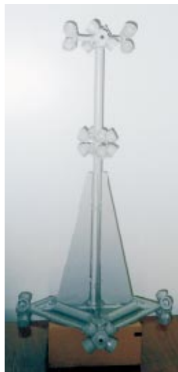
Рис. 2. Макет наноспутника “Рефлектор” с пассивной гравитационной системой ориентации
