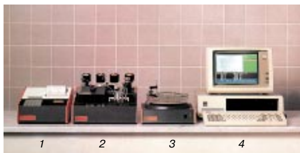
Рис. 4. Проточно-инжекционный анализатор фирмы "Tecator": 1 – самописец и цифropечатающее устройство, 2 – аналитический блок с двумя программируемыми перистальтическими насосами, 3 – автоматическое проботборное устройство, 4 – дисплей монитора
