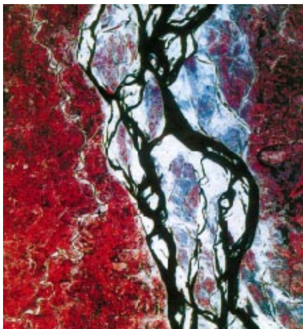
Рис. 3. Иконокарта участка долины реки Брахмапутры (Бангладеш) со множеством русел и рукавов. Составлена на основе цифрового монтажа космических снимков, трансформированных в проекцию топографической карты в масштабе 1 : 50 000 [6]
