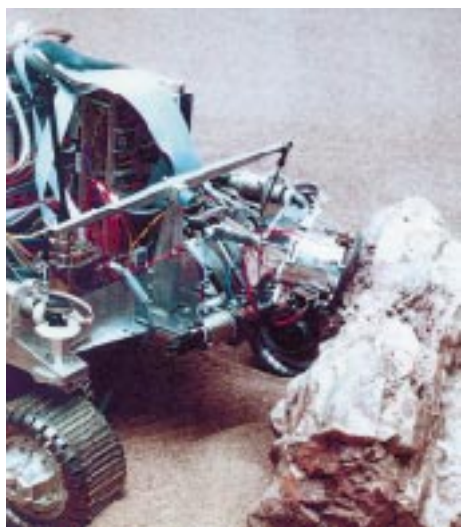
Рис. 4. APX-спектрометр может анализировать не только марсианскую пыль, но и глыбы марсианских камней
