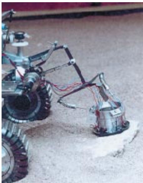
Рис. 2. Марсоход “Rover” “тренируется” в определении состава пород перед отправлением на Марс. Цилиндрическое устройство справа – АРХ-спектрометр для химического анализа марсианских пород
