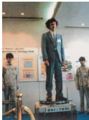
Рис. 5. Левитация магнитного диска над диамагнитным керамическим постаментом
