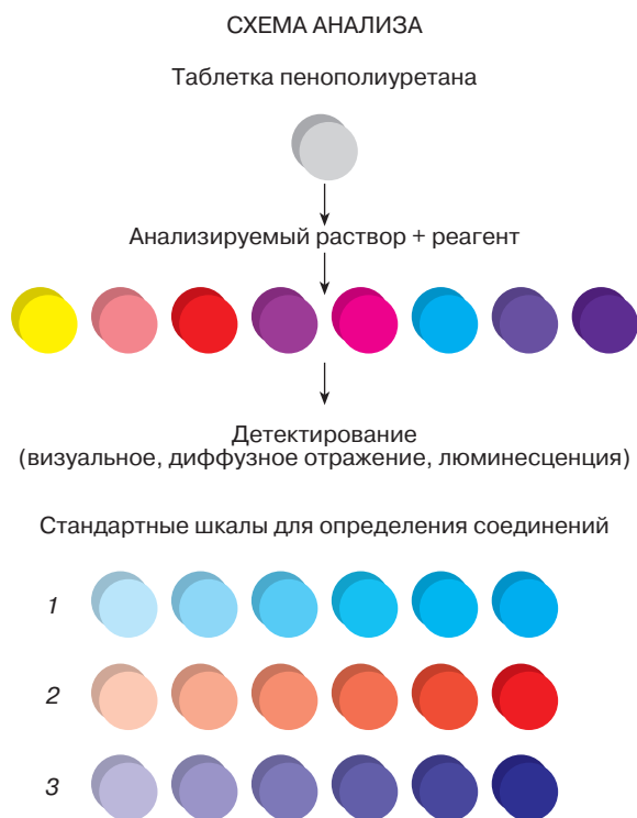
Рис. 2. Схема анализа окрашенных соединений с применением пенополиуретанов и стандартные шкалы для визуального определения соединений: 1 – \text{Co}^{2+} в виде [\text{Co}(\text{NCS})_4]^{2-} ; 2 – анионных поверхностно-активных веществ в виде ассоциата с фенантролиновым комплексом Fe(II); 3 – катионных поверхностно-активных веществ с сульфоталеиновым красителем бромфеноловым синим
