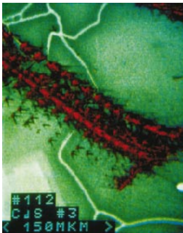
Рис. 3. Изображение кристалла сульфида кадмия с прочерченной металлическим ножом полосой в режиме цветной КЛ. Снимок любезно предоставлен Г.В. Сапариным
