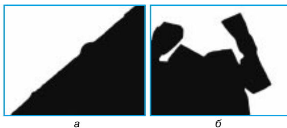
Рис. 2. Электронно-микроскопические снимки платиновой сетки: a – силуэт сетки до работы; б – после окисления аммиака при 800°C в течение 25 часов
