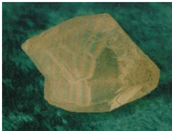
Рис. 8. Остановившаяся трещина в кристалле окиси магния.
