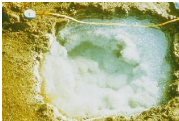
Рис. 5. Новообразования карбонатов и гидроксидов в пустотах намывных зологрунтов (фото Е.Н. Огородниковой).
